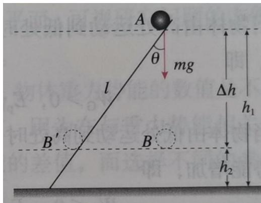
我们知道某个力做功的大小只取决于力、物体在力的方向上的位移及力和位移的夹角，与物体是否受其他力及运动状态等无关，故斜面是否光滑对计算“重力做的功”无影响。
